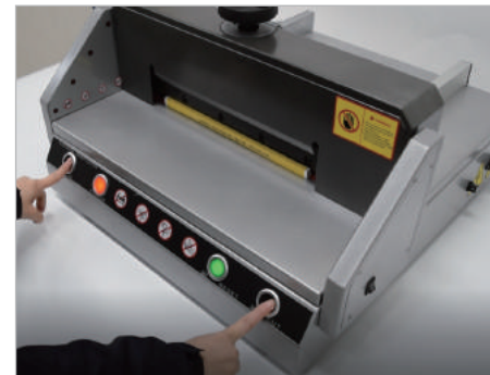
⑤ 리셋버튼을 눌러 레이저로 표시되는 재단선 확인 후 양쪽의 재단버튼을 동시에 눌러 재단해 줍니다.
